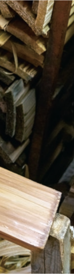
[右] 金槌で丸太を割っていく、藤井製桶所での製桶作業 [上] 樽丸 くりやまの大口孝次さん。吉野杉の買い付けから「樽丸」と呼ばれる樽材製作までを請け負う、数少ない職人だ [下] 丸太を6等分した大割。吉野杉は年輪が密。特に外側の白い部分と赤い部分の境が水が漏れにくく、この境目を含めて樽丸を作るのが肝要だそう [左] 銚いで樽丸を削る大口さん。工房は杉の芳しい香りで満ちている
