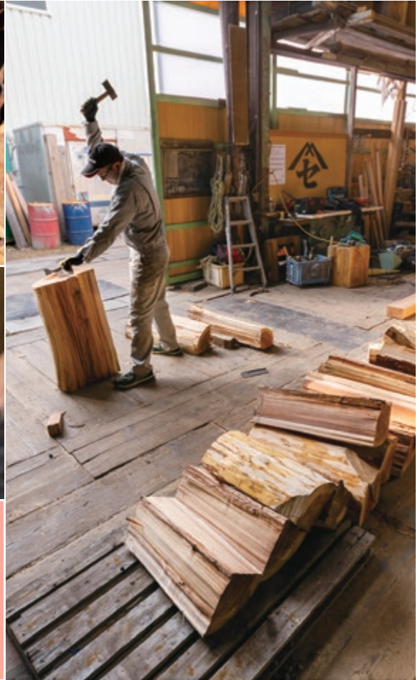
[右] 金槌で丸太を割っていく、藤井製桶所での製桶作業 [上] 樽丸 くりやまの大口孝次さん。吉野杉の買い付けから「樽丸」と呼ばれる樽材製作までを請け負う、数少ない職人だ [下] 丸太を6等分した大割。吉野杉は年輪が密。特に外側の白い部分と赤い部分の境が水が漏れにくく、この境目を含めて樽丸を作るのが肝要だそう [左] 銚いで樽丸を削る大口さん。工房は杉の芳しい香りで満ちている
