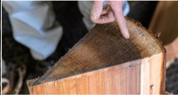
[右] 金槌で丸太を割っていく、藤井製桶所での製桶作業 [上] 樽丸 くりやまの大口孝次さん。吉野杉の買い付けから「樽丸」と呼ばれる樽材製作までを請け負う、数少ない職人だ [下] 丸太を6等分した大割。吉野杉は年輪が密。特に外側の白い部分と赤い部分の境が水が漏れにくく、この境目を含めて樽丸を作るのが肝要だそう [左] 銚いで樽丸を削る大口さん。工房は杉の芳しい香りで満ちている
